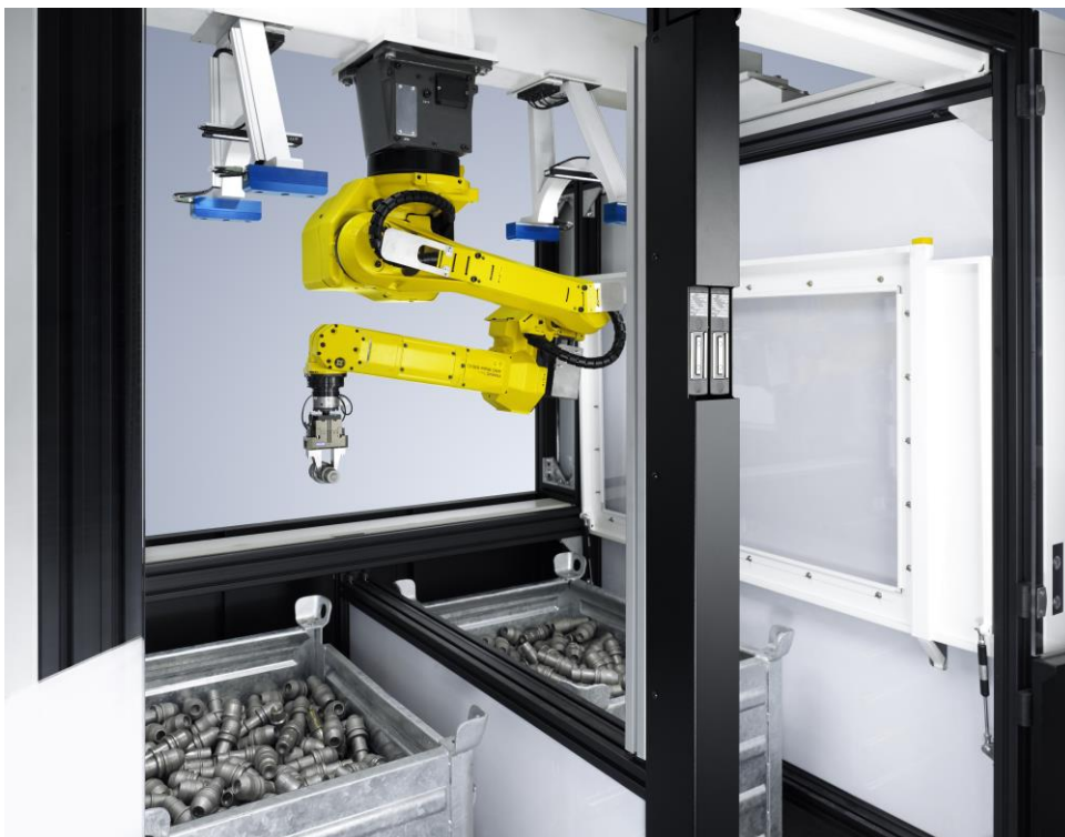
Zwei Ensensio N10 Stereo-3D-Kameras sind pro Kiste stationär installiert
